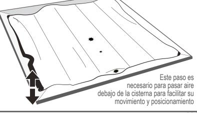
Agitar y extender correctamente la cisterna para eliminar todos los pliegues
