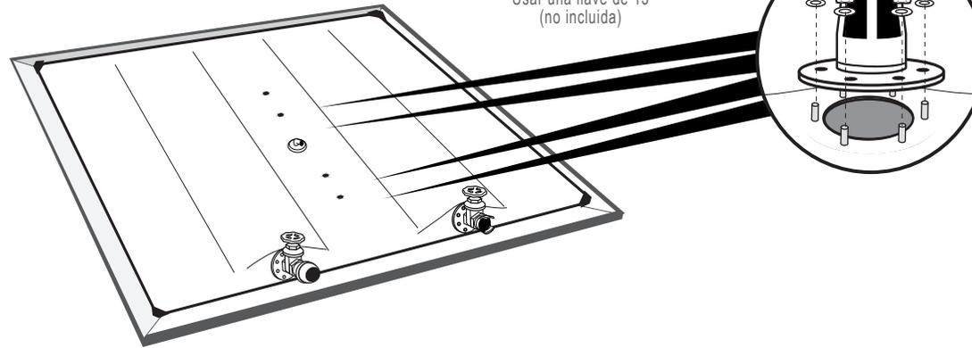
**!** Un apriete excesivo puede conducir a una rotura de la contrabrida
