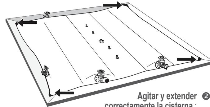
**2** Agitar y extender correctamente la cisterna : ningún pliegue tiene que aparecer en la superficie antes de llenar
