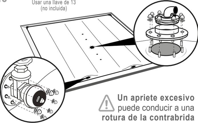
**!** Un apriete excesivo puede conducir a una rotura de la contrabrida
